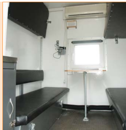
Бытовой отсек. Спальные места. Стол. Мойка с емкостью для воды, водонагревателем и устройством принудительной подачи воды. Переговорное устройство. Кондиционер.
