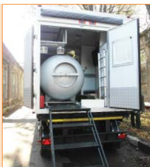
Лечебный отсек. Транспортная барокамера. Рабочее место врача-специфизиолога.
