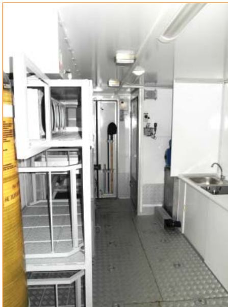
Бытовой отсек. Спальные места. Стол. Мойка с емкостью для воды, водонагревателем и устройством принудительной подачи воды. Переговорное устройство. Кондиционер.
