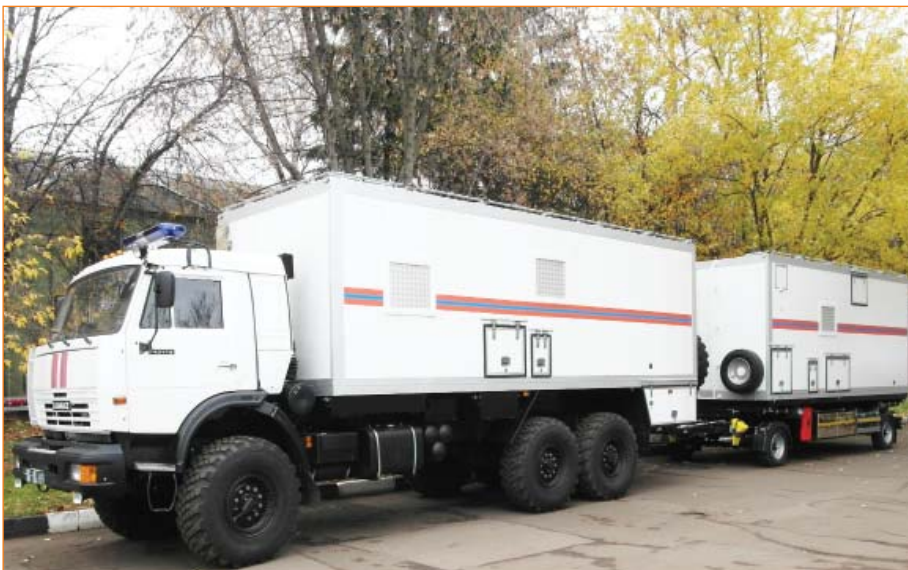
Мобильный водолазный комплекс МВК. Отсек для автономного дизель генератора. Открывается наружу и внутрь кузова. Наружные подвесные боковые ящики для инструмента и оборудования.
