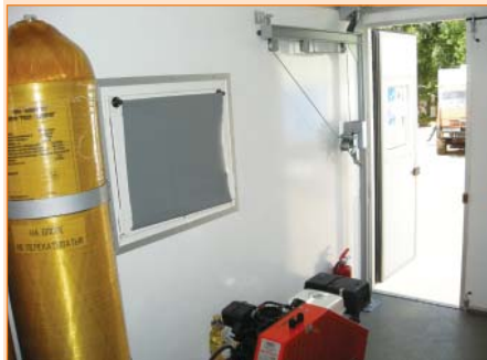
Грузоподъемное устройство облегчит погрузку, выгрузку и перемещение внутри кузова компрессора и других грузов.
