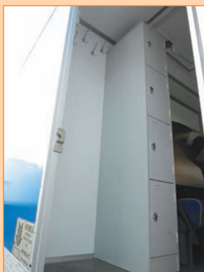
Пассажирский отсек. Сидения пассажирские с ремнями безопасности. Стол откидной для работы с документами. Полка верхняя для приборов и принадлежностей с раздвижными дверями. Шкаф для приборов и документации. Ящик для диэлектрических перчаток.
