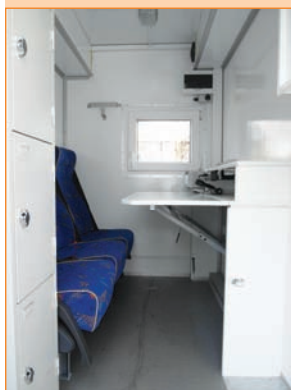
Пассажирский отсек. Сидения пассажирские с ремнями безопасности. Стол откидной для работы с документами. Полка верхняя для приборов и принадлежностей с раздвижными дверями. Шкаф для приборов и документации. Ящик для диэлектрических перчаток.
