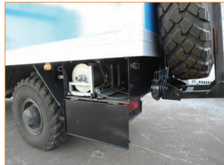
Ящик под кузовом для размещения катушки с кабелем и электроввода - под кузовом с левой стороны
