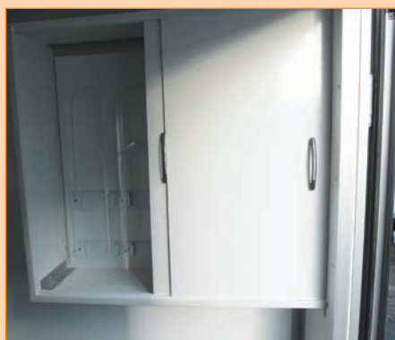
Пассажирский отсек. Сидения пассажирские с ремнями безопасности. Стол откидной для работы с документами. Полка верхняя для приборов и принадлежностей с раздвижными дверями. Шкаф для приборов и документации. Ящик для диэлектрических перчаток.
