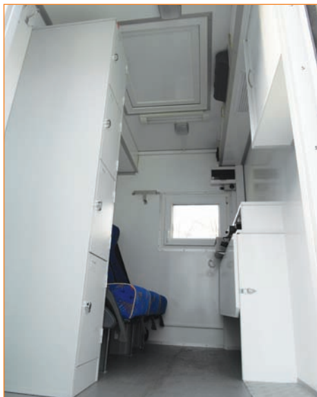
Пассажирский отсек. Сидения пассажирские с ремнями безопасности. Стол откидной для работы с документами. Полка верхняя для приборов и принадлежностей с раздвижными дверями. Шкаф для приборов и документации. Ящик для диэлектрических перчаток.
