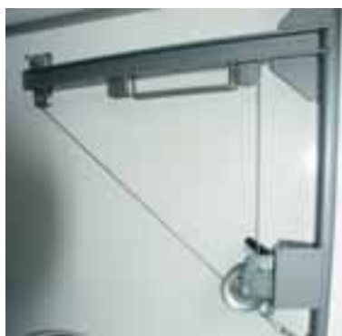
Грузоподъемное устройство для погрузки-выгрузки оборудования и запасного колеса (до 250 кг)
