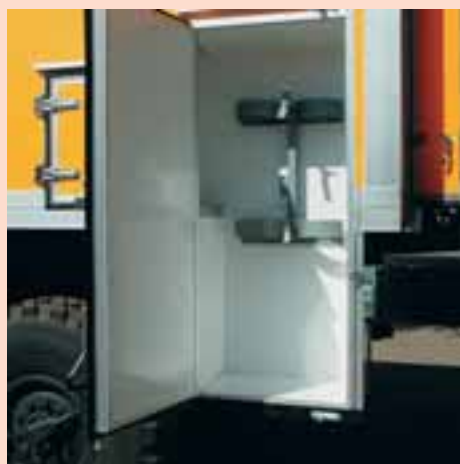
Удобные внешние отсеки для раздельной перевозки баллонов
