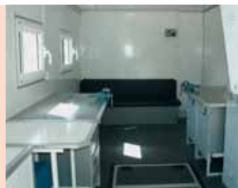
Кузов состоит из одного общего просторного отсека. В полу кузова — люк для генератора от КОМ автомобиля
