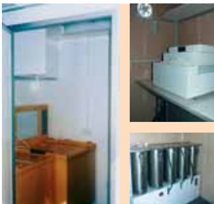
Отсек для проявки и работы с пленками. Машина для проявки и сушки пленок. Сосуды из нержавеющей стали для реактивов.
