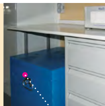
Ящик с набором матриц для опрессовки кабелей сечением 70-600 мм
