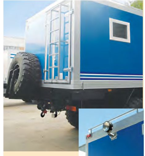
Держатель запасного колеса за кузовом. Лестница для подъема на крышу кузова
