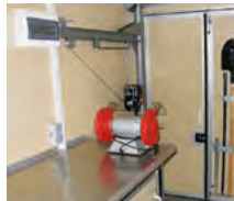
Кран-укосина для подъема тяжелых грузов (до 300 кг) в рабочий отсек. Стол-верстак с выгородкой для дизель-генератора. Точильно-шлифовальный станок.
