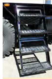
Лестница-трап. В транспортном положении размещается в ящике под кузовом. Глубина ступенек 200 мм, шаг между ступеньками 315 мм, что обеспечивает удобный и безопасный подъем/спуск
