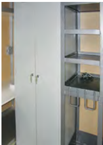
Шкаф для одежды с подводом горячего воздуха для просушки одежды. Стеллаж для перевозки принадлежностей. Полки оборудованы специальными бортиками для предотвращения падения предметов с полки
