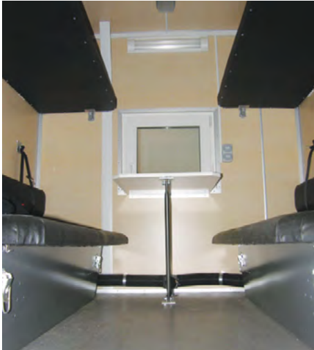
Пассажирский отсек. Диван-рундук (2 шт) с вентиляционными отверстиями и ремнями безопасности. Стол откидной. Полка верхняя с креплениями в поднятом положении (2 шт).
