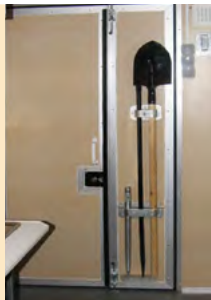
На задней полуотворочной двери установлены крепления для шанцевого инструмента
