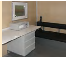
Стол с выдвигаемыми ящиками для инструментов. Преобразователь МАП «Энергия» (24В/220В). Диван-рундук в рабочем отсеке оборудован ремнями безопасности для перевозки людей
