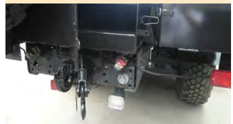
Подкузовной ящик-пенал (длиной до 4 м) для транспортировки длинномерных грузов
