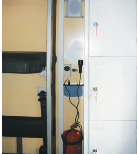
Шкаф с секциями для перевозки приборов. Изнутри шкаф отделан специальным материалом во избежание повреждения приборов при транспортировке. Переговорное устройство «кузов-водитель». Огнетушитель с креплением
