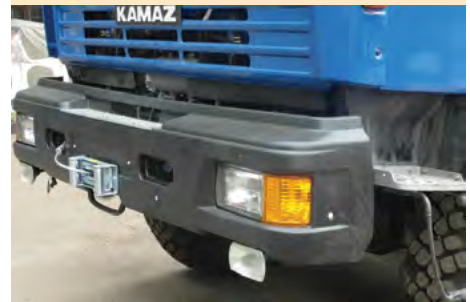
Передняя электрическая лебедка (24В, тяговое усилие 7т) для самовытаскивания и поднятия груза
