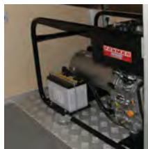
Выгородка для генератора с доступом с внутренней и внешней стороны кузова. Дизель-генератор EISEMANN. Предусмотрены салазки для легкого выдвижения дизель-генератора
