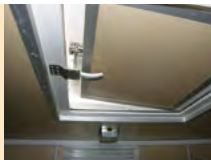
Аварийно-вентиляционный люк в потолке пассажирского отсека. Фиксатор открытого положения люка
